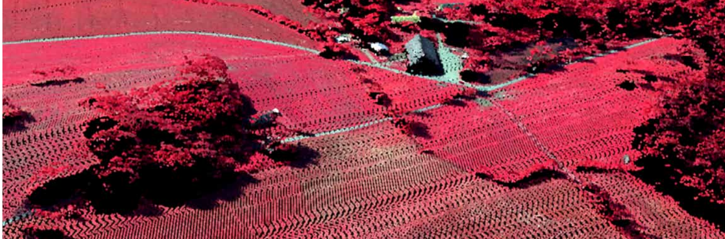
Bild 2. Exempel på ytmodell med färg från IR-flygbilder.
