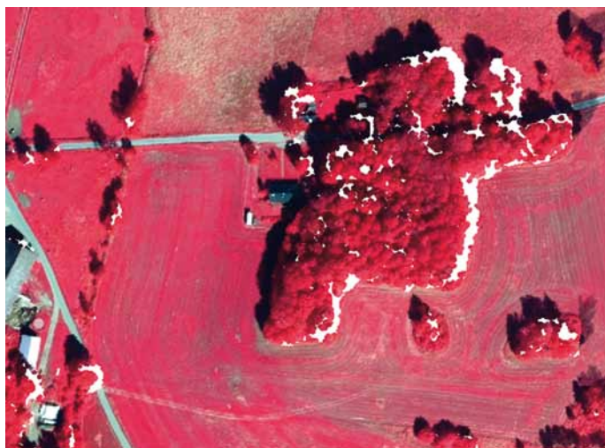
Bild 5. Ytmodellen från bildmatchning kommer att innehålla "hål" där matchningen inte "fått träff" mellan bildpixlarna.
