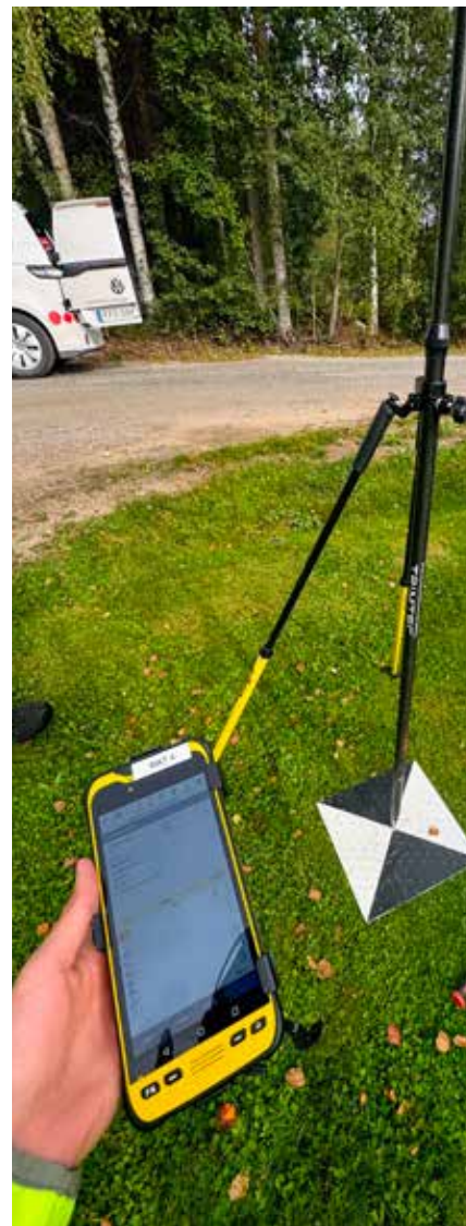
Inmätning av ett markstöd med GNSS
