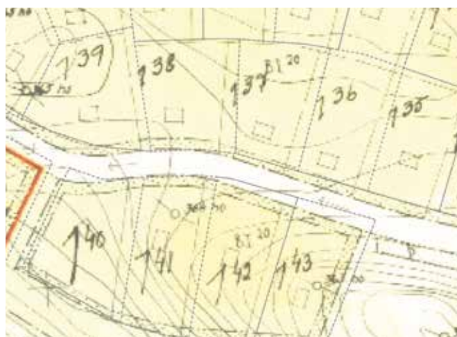
Äldre detaljplan med överlagrad transparent fastighetsgränsinformation som mäts in. Visar behov av tolkning av planens och fastigheternas gränser mot varandra vid renritning för digitalisering.
