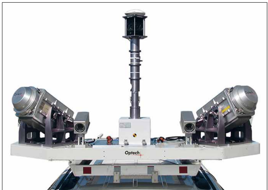
Det mobila laserskanningsystemet som användes är ett Optech Lynx med två laserskannrar och en 360-kamera på taket.
