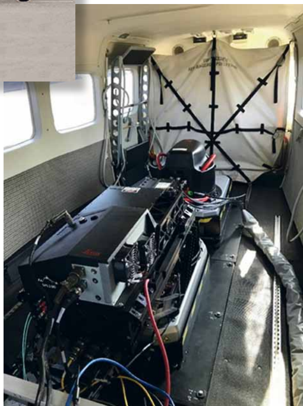
Figur 2 D-FCAE med SPL100-sensorn i förgrund och kamera DMCIII bakom, monterade i varsitt hål
