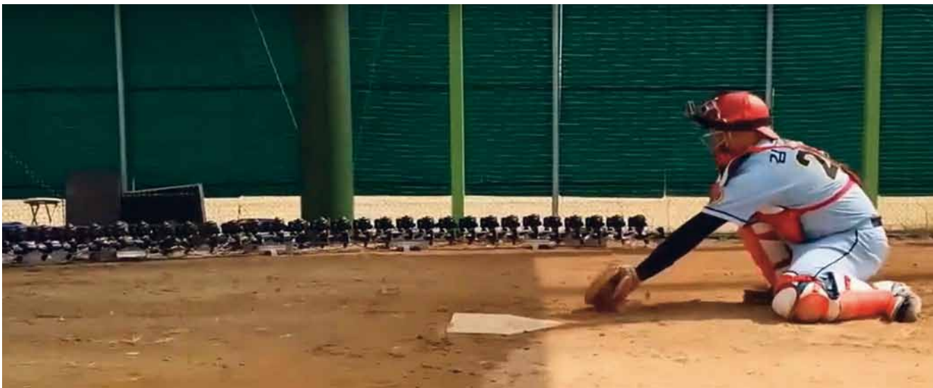
Figur 3. 4DReplay:s lösning med en lång rad systemkameror som filmar från lite olika vinklar.
