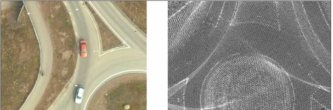
Stereobilder och laserdata kompletterar varandra i informationsinnehåll. Ur bilderna kan man lättare tolka informationen medan laserskanningen ger en lägre mätosäkerhet i höjd.
