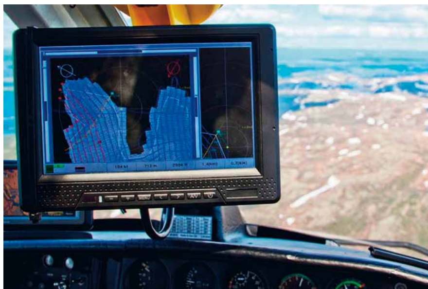
Ett detaljerat planeringsunderlag ger piloten stöd under flygningen. En preliminär täckningskontroll säkerställer att all data är insamlad.
