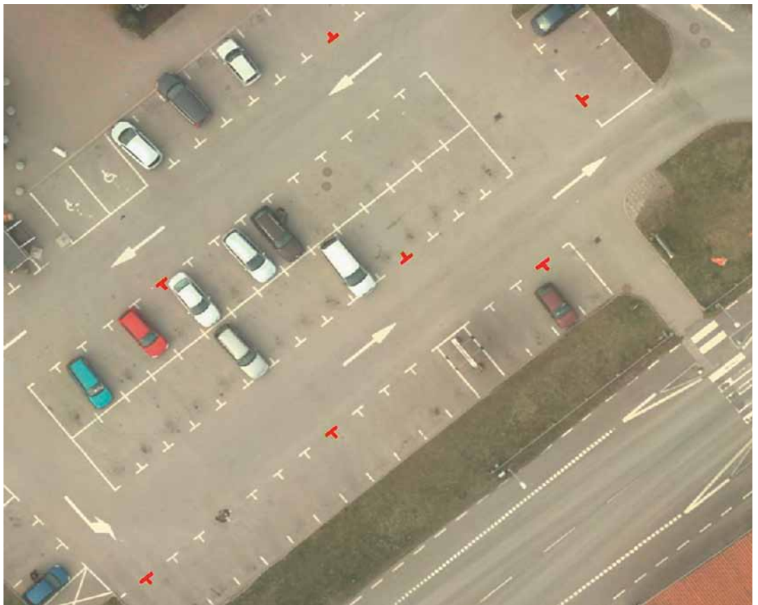
Exempel på kontrollpunkter som används för inpassning av flygbilderna.
