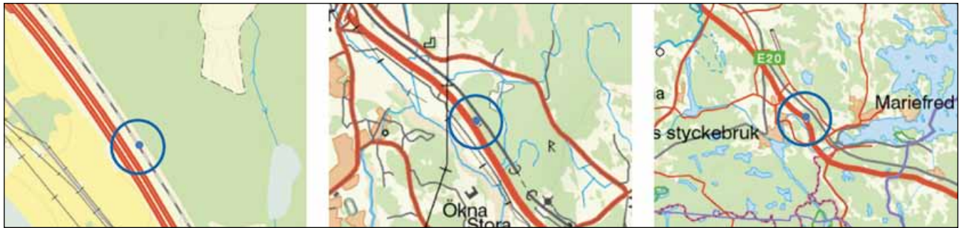
Bild 5. Observera hur järnvägen förflyttas ut från vägen när kartskalen blir mindre och det karterade området större. Källa: Geodata © Lantmäteriet.
