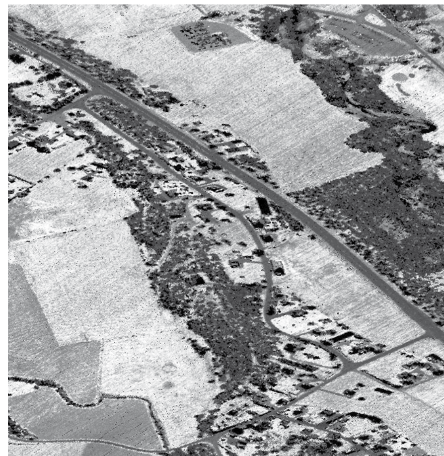
Erfaren personal hos Blom i Sollentuna kontrollerar täckning, punkttäthet och geometrisk kvalitet i punktmolnet.
