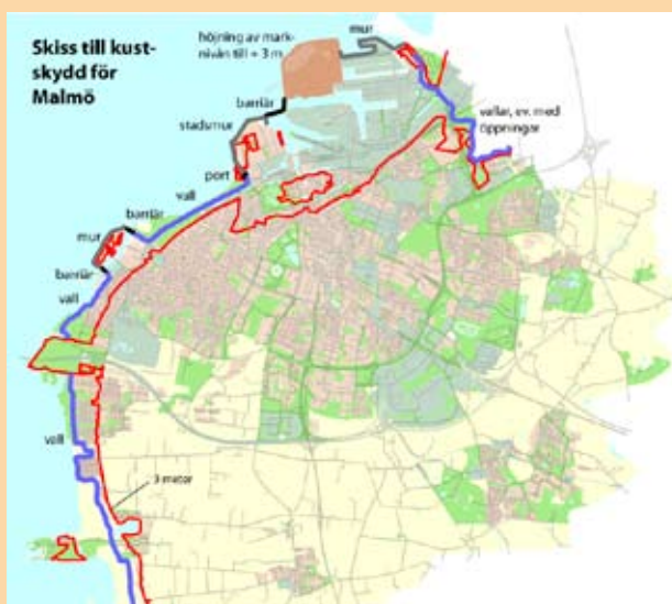
Preliminär skiss till översvämningsskydd för Malmös kust. Skissen utgår ifrån att kusten skall skyddas upp till nivån +3 meter över havet.
