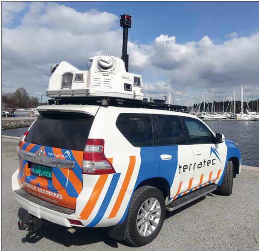
Figur b: Optech Lynx Mobile Mapper till vänster (TerraTec AS, 2016), två laserskannrar kan ses på taket av bilen monterad på hörnen bak. Den högra bilden visar en observation av ett objekt (den blå stjärnan) från skanner 1 vid tiden t_1 och från skanner 2 vid tiden t_2 .
