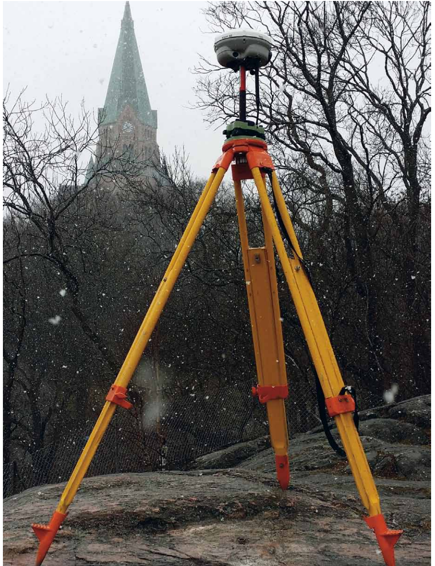
De första testmätningarna med RTK och Galileo genomfördes i ett examensarbete nedanför Sofiakyrkan i Vitabergsparken i Stockholm under våren 2016. Bild: Anna Berggren.
