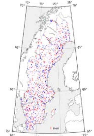
Figur 4: Skillnad mellan GNSS/avvägningsgeoidhöjder och SWEN08_RH2000. Röda och blåa pilar visar positiva respektive negativa avvikelser.
