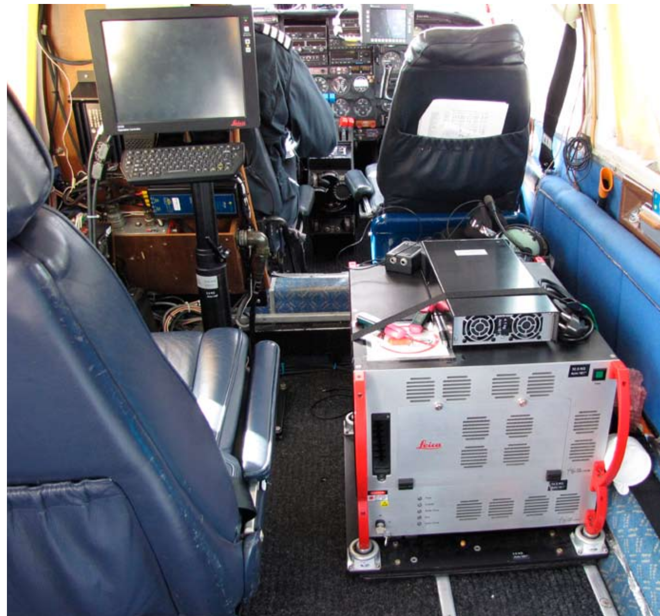
Interiör från operatörens (Blom) flygplan som visar styrenheten till skannern
