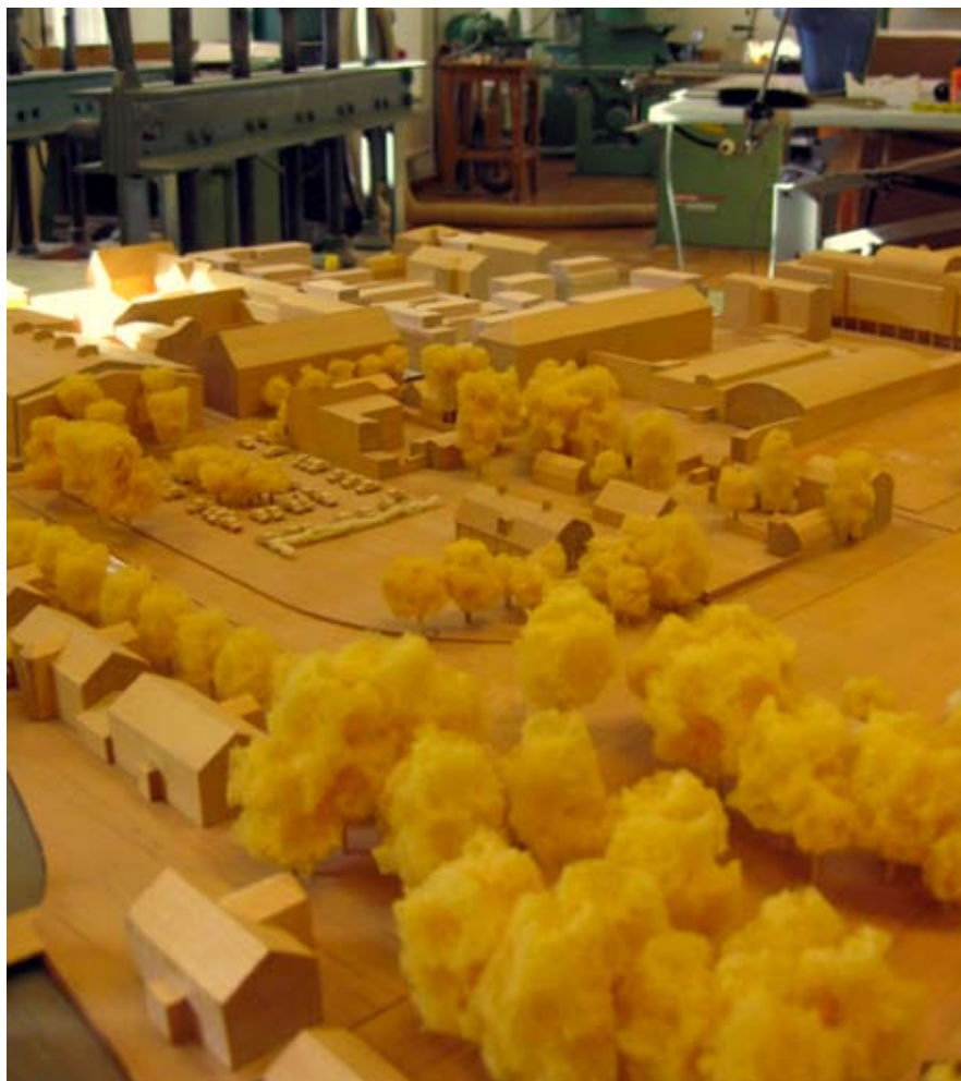
400-delsmodell under bearbetning i modellverkstaden
