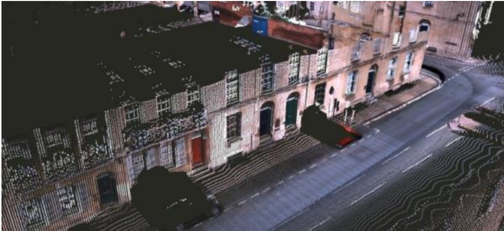
Punktmolnskarta från Oxford baserat på data från en kombinerad LIDAR och stereokamera (Bild: University of Oxford)
