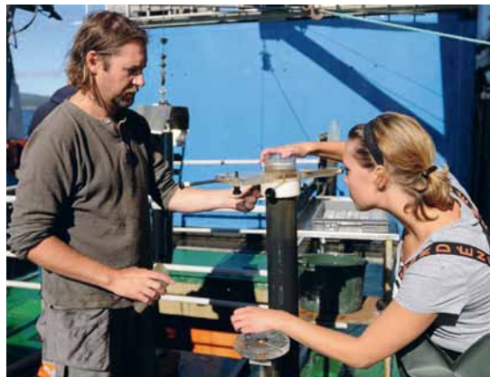
Ola Hallberg och Anna Apler snittar kärnor från ett sedimentprov.
